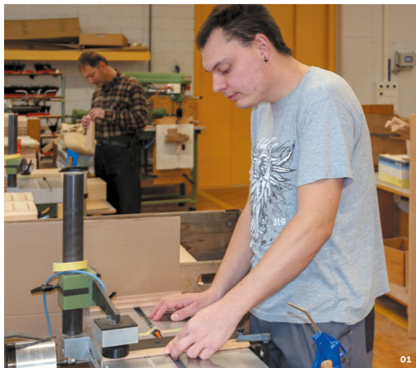
01 Patrick bei der Montage Die Tablar-einzelteile werden mit Dübeln verbunden.
