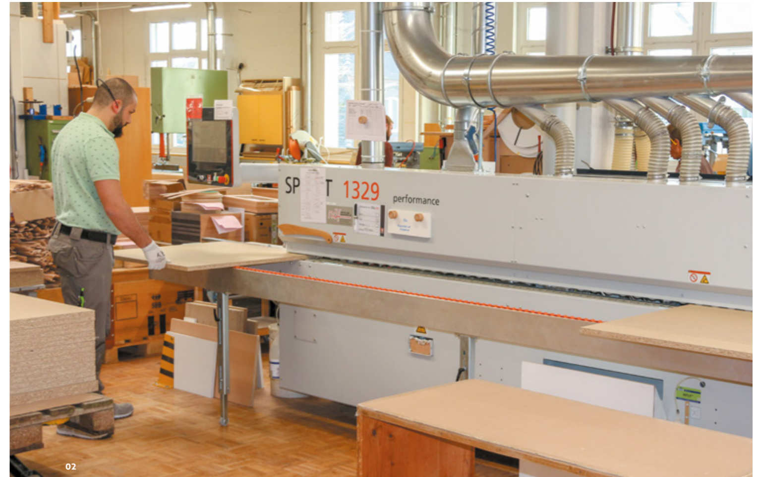
02 Die neue Kantenleim- maschine Reduziert den Aufwand auf 10% gegenüber vorher.
